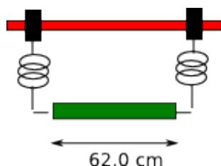
**Soluzione.** La massa di  $13.0\text{ g}$  ha un peso di  $P = 13.0 \cdot 10^{-3}\text{ kg} \times 9.81 \frac{\text{m}}{\text{s}^2} = 0.127\text{ N}$ . Per annullare la tensione meccanica la corrente deve generare una forza dello stesso valore ma di verso opposto, cioè verso l'alto. Calcoliamo questa corrente
