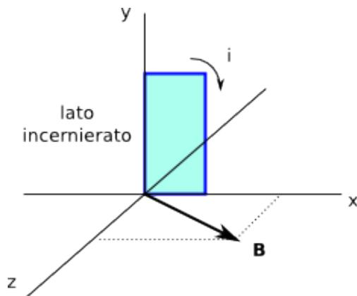
**Soluzione.** Calcoliamo le componenti del campo magnetico lungo gli assi  $x$  e  $z$ .
